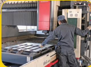
切断した断面は溶接にも影響するため緻密で正確な美しさが求められます。
