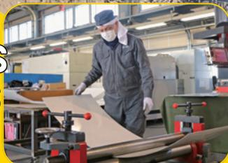
曲げ加工はパンチや曲げ型などでプレスし設計と通りの角度や形状に仕上げます。
